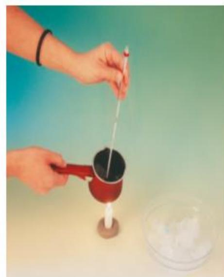
Βάλε στο μπρίκι λίγο νερό και πρόσθεσε δύο μεγάλα παγάκια. Ανακάτεψε καλά με το κουταλάκι. Στερέωσε ένα κερί στο θρανίο σου με πλαστελίνη και άναψε το. Κράτησε το μπρίκι πάνω από τη φλόγα του κεριού και μέτρα τη θερμοκρασία στο μπρίκι κάθε δύο λεπτά. Ανακάτευε το νερό όση ώρα μετράς τη θερμοκρασία. Τι παρατηρείς;
