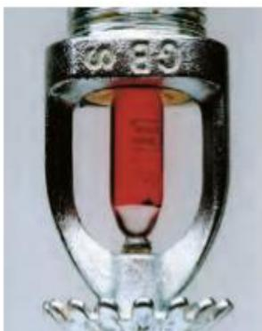
Στη διπλανή φωτογραφία βλέπεις ένα στόμιο από ένα σύστημα αυτόματης πυρόσβεσης. Σε διάφορα σημεία πολλών κτηρίων τα στόμια αυτά τοποθετούνται στην άκρη σωλήνων, που τροφοδοτούνται με νερό ή ειδικό πυροσβεστικό υγρό. Η κόκκινη αμπούλα, που είναι κατασκευασμένη από λεπτό γυαλί και περιέχει ένα υγρό, φράζει την παροχή του νερού. Αν ξεσπάσει πυρκαγιά στο κτήριο, η θερμοκρασία ανεβαίνει πολύ. Τότε η αμπούλα σπάει και το νερό ή το πυροσβεστικό υγρό σβήνει τη φωτιά.
