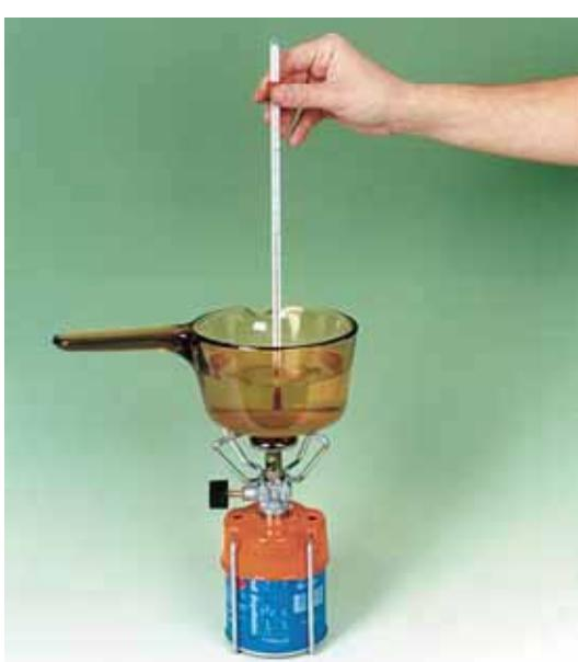
Η δασκάλα ή ο δάσκαλός σου έχει βάλει λίγο νερό σε ένα διάφανο πυρίμαχο δοχείο. Με ένα μαρκαδόρο έχει σημειώσει τη στάθμη του νερού στο δοχείο. Χρησιμοποιώντας ένα καμινέτο θερμαίνει το νερό στο δοχείο και μετρά τη θερμοκρασία του νερού κάθε δύο λεπτά. Αφού σβήσει το καμινέτο και περιμένει λίγο, για να κρυώσει το νερό, σημειώνει ξανά τη στάθμη του νερού στο δοχείο. Τι παρατηρείς;
