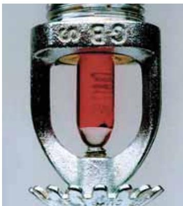
Στη διπλανή φωτογραφία βλέπεις ένα στόμιο από ένα σύστημα αυτόματης πυρόσβεσης. Σε διάφορα σημεία πολλών κτηρίων τα στόμια αυτά τοποθετούνται στην άκρη σωλήνων, που τροφοδοτούνται με νερό ή ειδικό πυροσβεστικό υγρό. Η κόκκινη αμπούλα, που είναι κατασκευασμένη από λεπτό γυαλί και περιέχει ένα υγρό, φράζει την παροχή του νερού. Αν ξεσπάσει πυρκαγιά στο κτήριο, η θερμοκρασία ανεβαίνει πολύ. Τότε η αμπούλα σπάει και το νερό ή το πυροσβεστικό υγρό σβήνει τη φωτιά.
