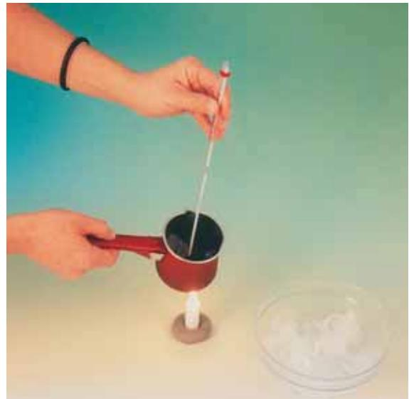
Βάλε στο μπρίκι λίγο νερό και πρόσθεσε δύο μεγάλα παγάκια. Ανακάτεψε καλά με το κουταλάκι. Στερέωσε ένα κερί στο θρανίο σου με πλαστελίνη και άναψε το. Κράτησε το μπρίκι πάνω από τη φλόγα του κεριού και μέτρα τη θερμοκρασία στο μπρίκι κάθε δύο λεπτά. Ανακάτευε το νερό όση ώρα μετράς τη θερμοκρασία. Τι παρατηρείς;
