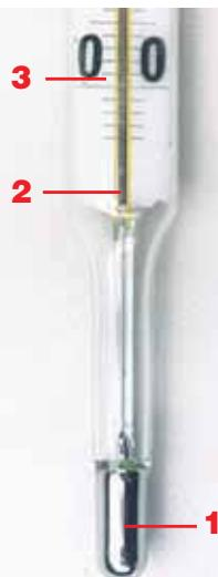
Για να μετρήσουμε τη θερμοκρασία με ακρίβεια, χρησιμοποιούμε ειδικά όργανα, τα θερμόμετρα. Στις εικόνες βλέπεις ένα γνώριμο τύπο θερμομέτρων, στα οποία η ένδειξη δίνεται από κάποιο υγρό. Συνήθως χρησιμοποιούμε υδράργυρο ή χρωματισμένο οινόπνευμα. Τα θερμόμετρα υδραργύρου και τα θερμόμετρα οινοπνεύματος μπορεί να περιέχουν διαφορετικό υγρό και να έχουν διαφορετικό σχήμα, έχουν όμως όλα:
